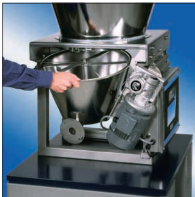
Obr. 83 Detailní pohled na násypku s vertikálním aktivátorem
