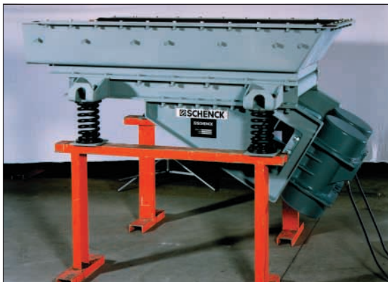
Obr. 72 Vibrační žlab pro přímý odtah materiálu ze síla
