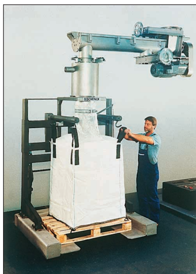
Obr. 15 Modifikace plošinové váhy pro plnění obalů Big-Bag
