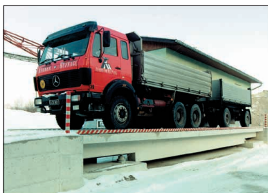
Obr. 9 Mostová váha pro silniční vozidla
