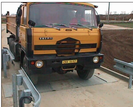
Obr. 28 Váha pro vážení silničních vozidel za pohybu
