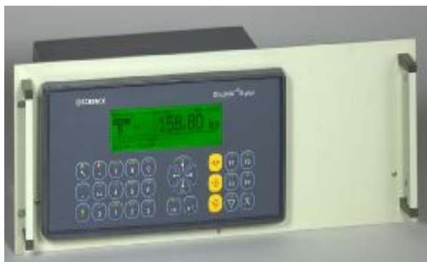
Provedení do 19" rámu VNG 20400 Hloubka 195 mm + 25 mm pro kabely Stupeň krytí: IP 54 čelní stěna, ostatní IP 20 Hmotnost: 7,5 kg
